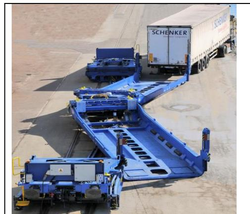
Abbildung 9: Entladevorgang durch MegaSwing
