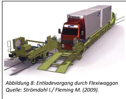
Abbildung 8: Entladevorgang durch Flexiwaggon
