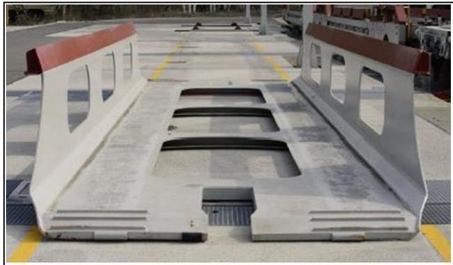
Abbildung 20: Waggonaufsatz von CargoBeamer
