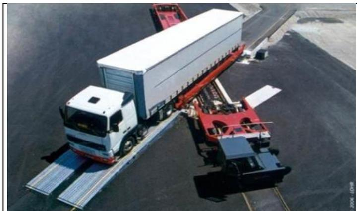
Abbildung 19: Sattelauflegerumschlag durch das Lohr System
