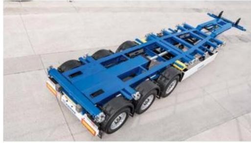
Abbildung 9: Containerchassis mit Heckausschub
