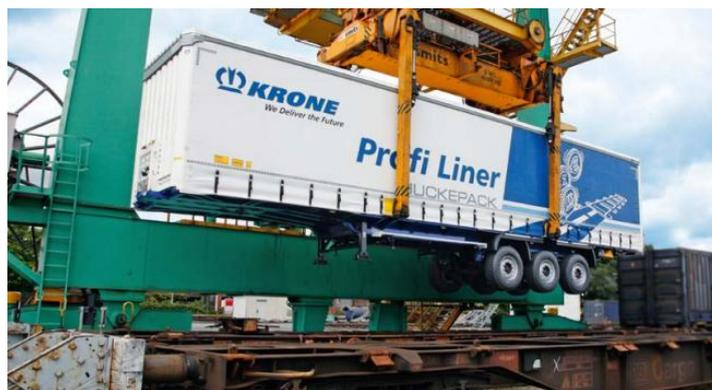
Abbildung 10: Ein kranbarer Sattelaufleger bei der Bahnverladung
